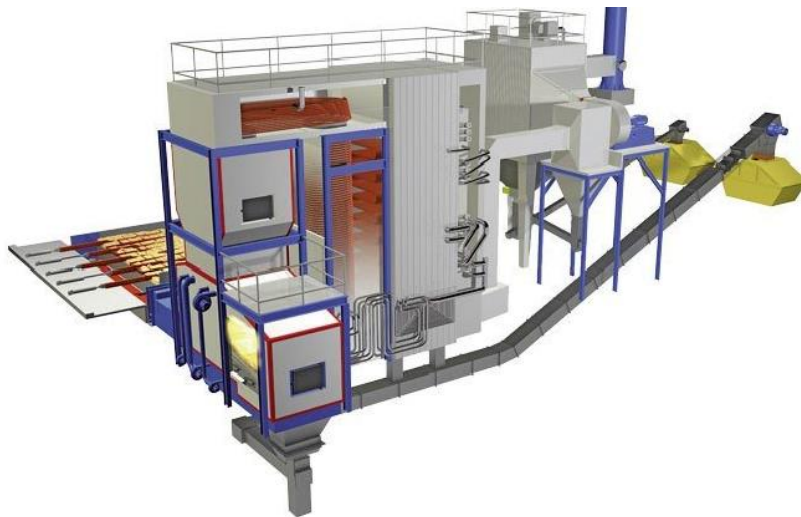
Obrázek 39: Pohled na typové provedení velkého kotle na biomasu
