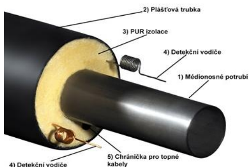
Obrázek 61: Konstrukce potrubí pro horkovodní a teplovodní rozvody
